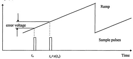
Fig. 2.28. Time-to-voltage conversion technique.
