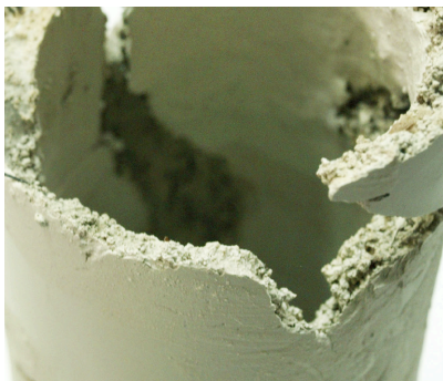
fig 2 – pormenor de ensaio com formigas
