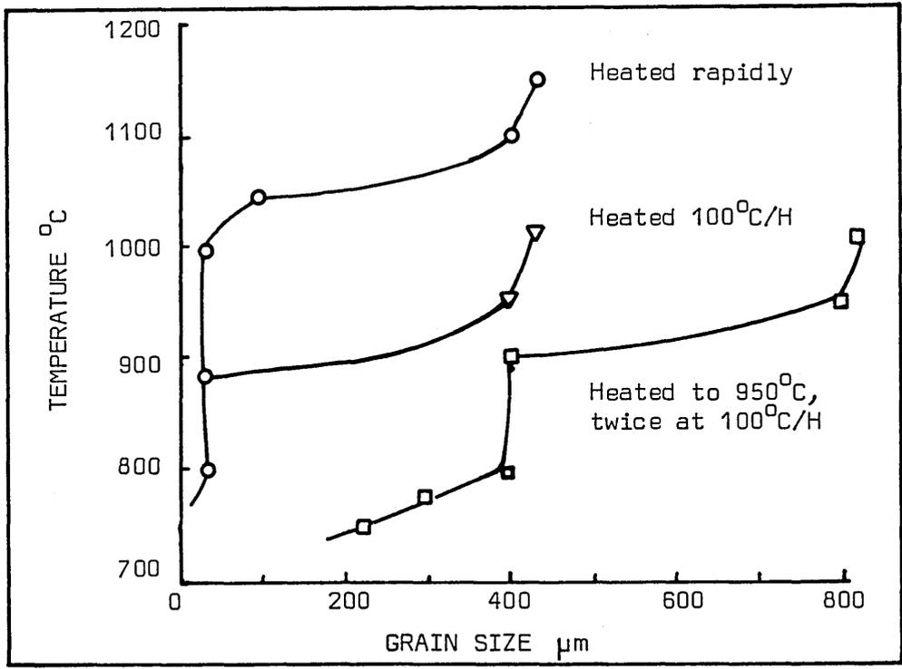
FIG. 17 GRAIN SIZE ON REHEATING C-Mn VANADIUM STEEL
