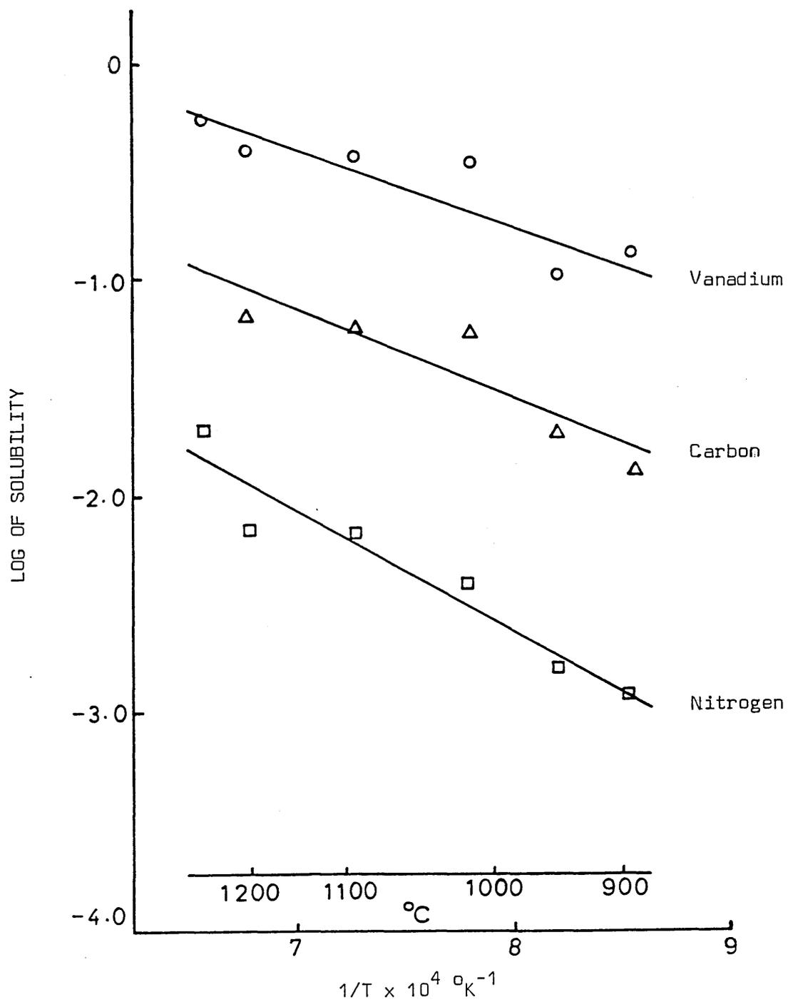
FIG. 35 EFFECT OF SOLUTION TREATMENT TEMPERATURE ON THE SOLUBILITY OF VANADIUM, CARBON AND NITROGEN IN 0.126%C 1.77%Mn 0.415%V 0.020%N STEEL
