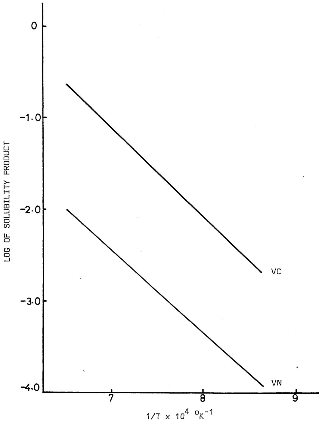
FIG. 37 SOLUBILITY PRODUCT - TEMPERATURE RELATIONSHIP OF VANADIUM CARBIDE AND VANADIUM NITRIDE IN 0.12%C, 1.77%Mn, 0.15%V, 0.020%N STEEL
