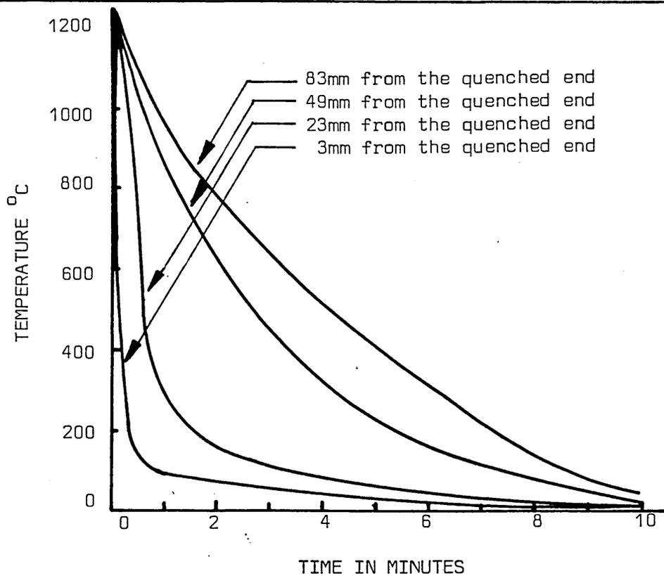
FIG. 74 TYPICAL COOLING CURVES FOR VARYING DISTANCE FROM FROM THE QUENCHED END OF MODIFIED JOMINY SPECIMEN
