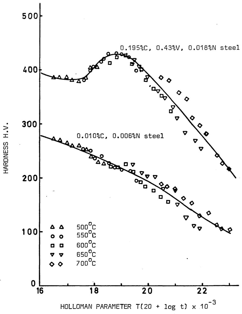
FIG. 52 SCATTER EFFECT OF HARDNESS VERSUS HOLLOMAN PARAMETER
